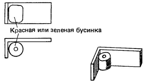
Рис. 19. Выполнение ходовых огней.
